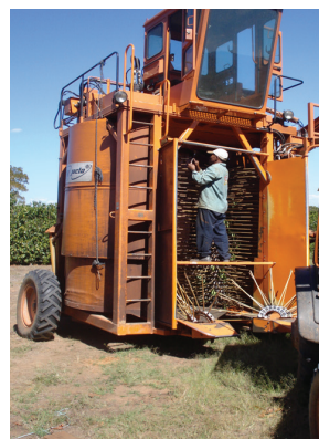
Máquina colhedeira KTR da Jacto, usada na colheita do conillon em Pirapora
