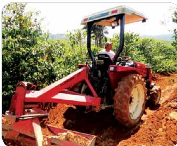
O sistema inicial de abertura de micro-terraços, com trator trabalhando de ré, com lâmina traseira.
