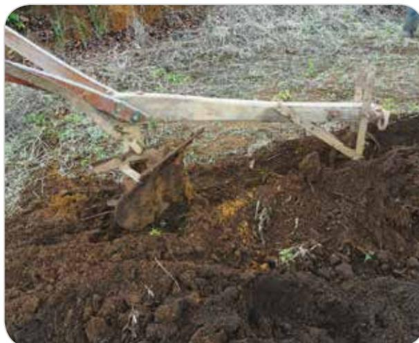
Arado leve, helicoidal, para tração, por um só animal, visando cortar o terreno e afogar a terra, na construção dos micro-terraços.
