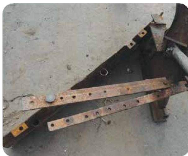
Detalhe da lâmina, vendo-se os eixos de posicionamento e a sua fixação na base de um estrutura de arado de tração animal.
