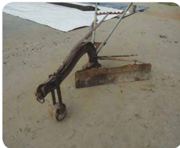
Lâmina de tração animal desenvolvida para retirar terra e plainar o piso do micro-terraço.
